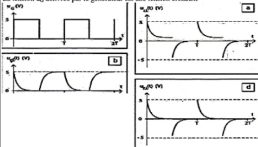
Quelle courbe peut représenter la tension  $u_L$  aux bornes de la bobine:
